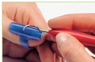
Auf beiden Seiten des LM-RondoPlus™ steckt ein LM-Fingo™-Teststift. Beim Schärfetest kann der Stift entweder am LM-RondoPlus™ oder am Finger fixiert werden. Fingo besteht aus Acryl und ist für alle Größen passend.
