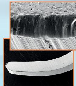
Die Schneide einer typischen unbeschichteten Kurette und Vergrößerung der Kante nach dem Test.
