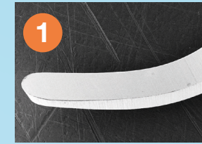
Sharp Diamond -kyretin leikkaava reuna ja sen suurennos kulumistestauksen jälkeen* (Kuvat 1 ja 2)
