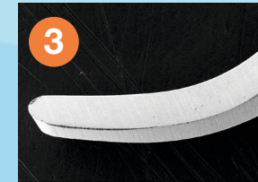
Tyypillisen ei päällystetyn kyretin leikkaava reuna ja sen suurennos kulumistestauksen jälkeen* (Kuvat 3 ja 4)
