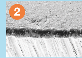
Sharp Diamond -kyretin leikkaava reuna ja sen suurennos kulumistestauksen jälkeen* (Kuvat 1 ja 2)
